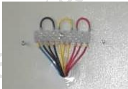
شکل (۳): محل و نحوه خروج سیم‌ها از صفحه نگهدارنده
