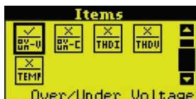
Figure 63 حفاظت از ولتاژ خارج از محدوده فعال
