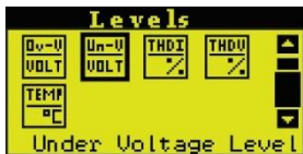
تنظیم مقدار کمینه ولتاژ Figure 75
