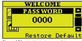
Figure 121 رمز عبور بازگشت به تنظیمات کارخانه
