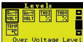
تنظیم مقدار بیشینه ولتاژ Figure 73
