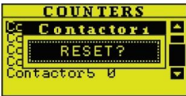
Figure 104 پاک کردن شمارنده قطع و وصل کنتاکتور
