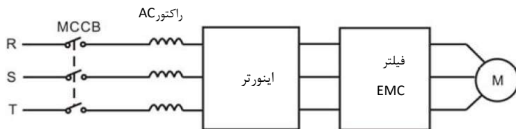
نصب فیلتر EMC در خروجی درایو
